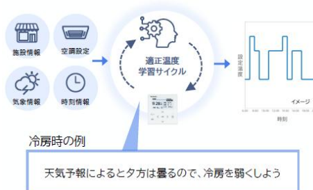
Panasonic HVAC CLOUD AI による自動制御イメージ
