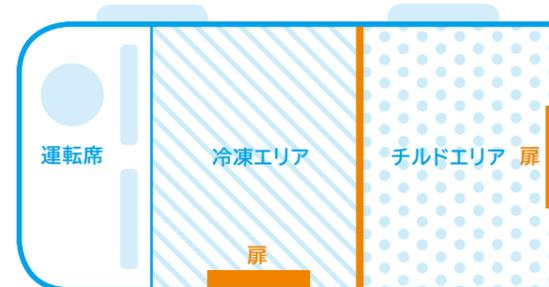
トラックの荷台内には仕切りを設けて温度管理。食材を良好な状態のままお届けするために、扉は冷凍・チルド側の両方に設置して、開閉時間を最小限におさえています
