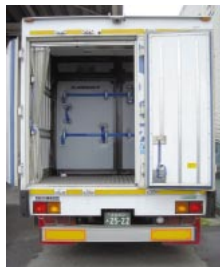
仕切り板より奥が冷凍室、手前が冷蔵室と常温室になっています
